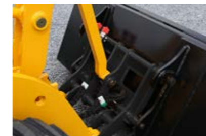
"SWH"-redskapsfästet stöder snabb koppling och fränkoppling av alla redskap. Hydraul-låsning är standardutrustning.
