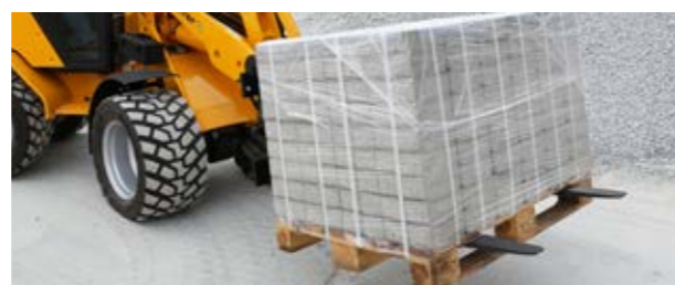
3450S kan transportera pallar som väger 2,0 ton. Det smala och mycket låga frontpartiet gör att föraren har optimal överblick över redskapet.
